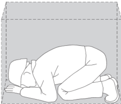
Rys. 10: Przestrzeń bezpieczeństwa w podszyciu (wysokość 700 mm)
