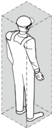
Rys. 14: : Przestrzeń bezpieczeństwa w nadszybiu (wysokość 2000 mm)
